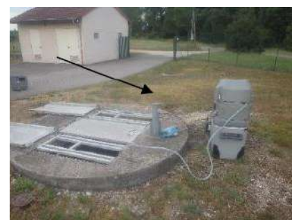
Figure 9: Préleveur automatique utilisé pour réaliser le bilan 24h à la sortie du premier étage de la station
