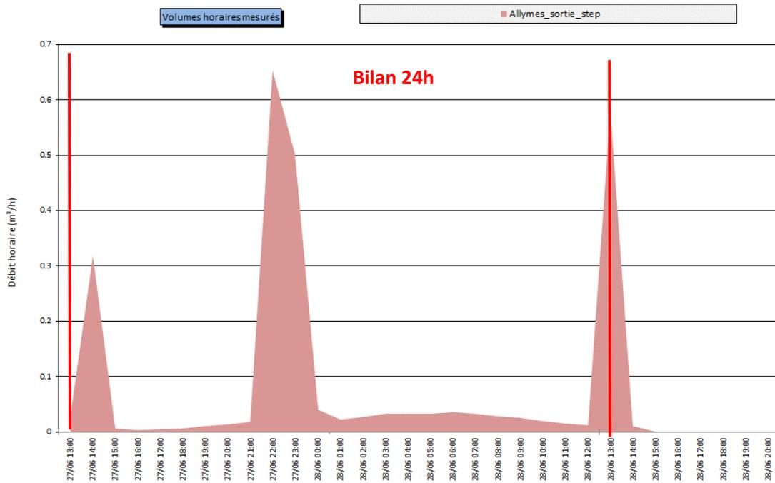
L'analyse du graphique met en évidence des pics de débits soudains dus au fonctionnement de la station (alimentation du lit par bâchée).
