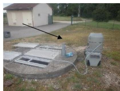
Figure 2: Préleveur automatique utilisé pour réaliser le bilan 24h à la sortie du premier étage de la station
